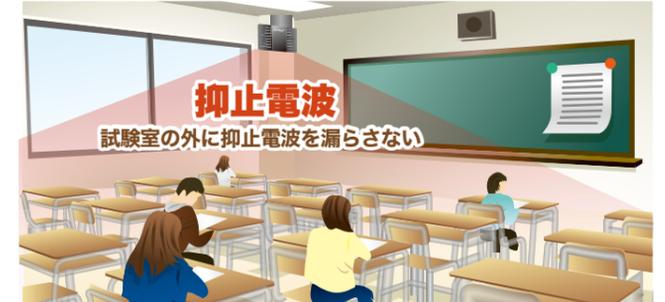
試験会場の窓ガラス等にシールド材を貼付しテレ・ポーズとの併用により、試験会場のみを圏外エリアにすることができます。
